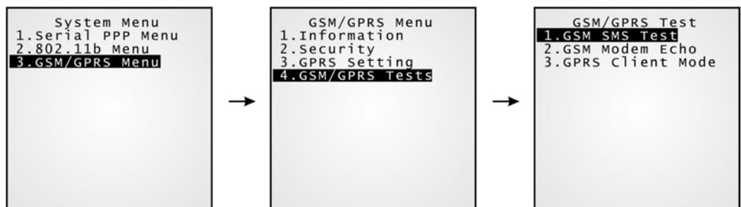
1. GSM SMS Test: Данный GSM Sending Тест используется для проверки службы коротких сообщений (SMS). Введите номер абонента.
