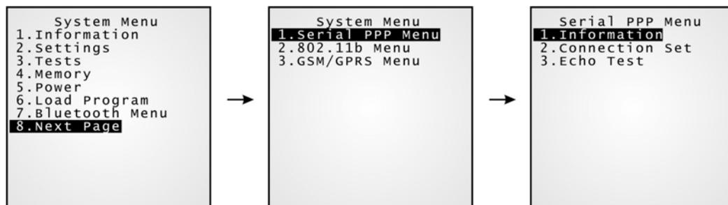
Примечание: Point-to-Point Protocol (PPP) - это способ подключения терминала к Интернету, в последовательных сетях. С помощью него посылаются пакеты TCP/IP на сервер, который имеет подключение к интернету.
