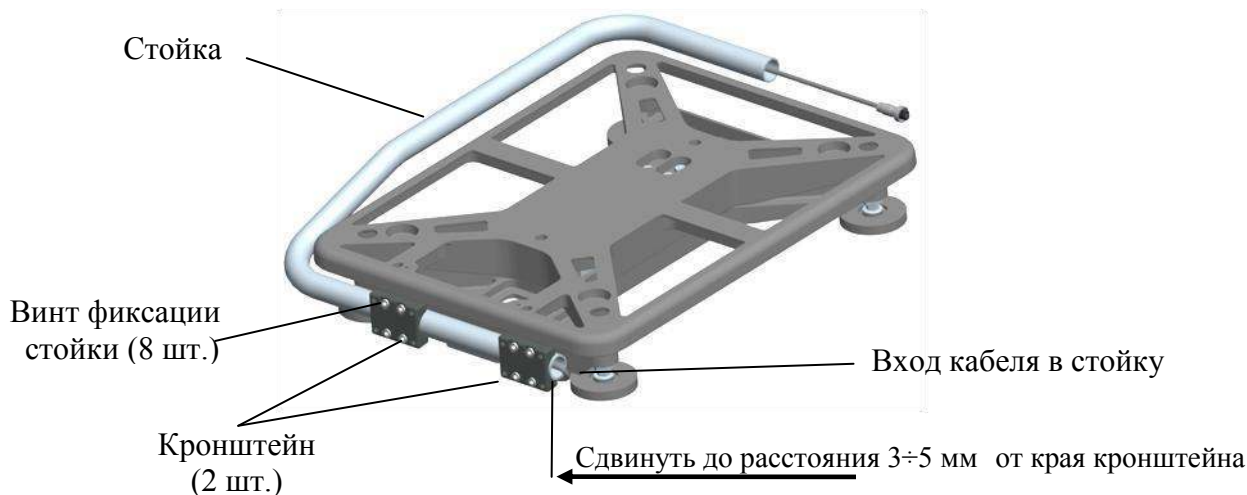
Рисунок 2 – Установка круглой вращающейся стойки
